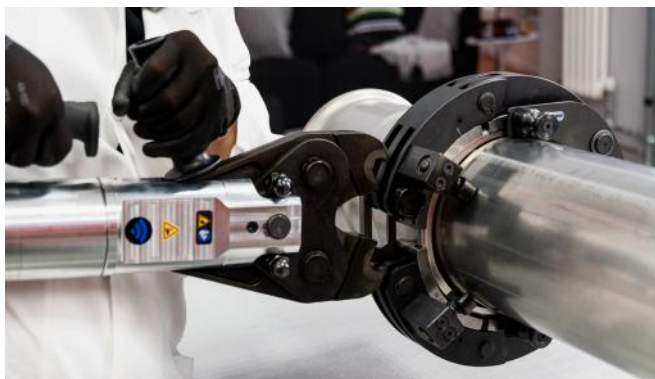
Bilde 34 - Montering av press, 1. fase
