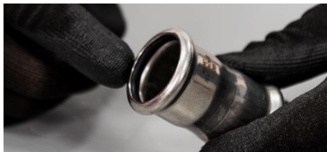
Bilde 30 - Kontroll av tetningsring
