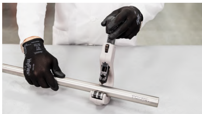
Bilde 25 - Tilkutting av rør
