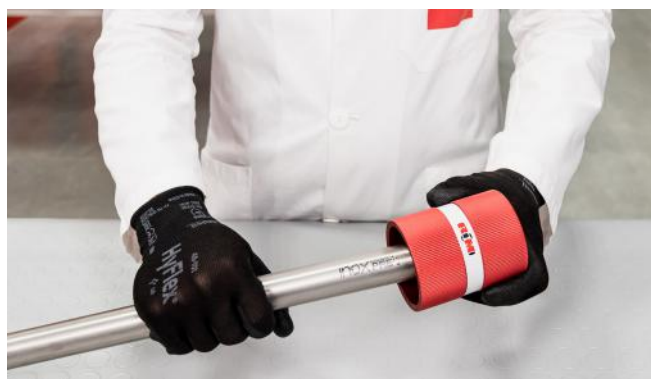
Bilde 26 - Avgrading av rør
